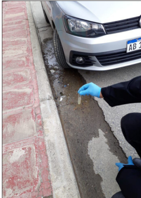
Con la ayuda de reactivos químicos, se determina si la pérdida es de agua potable.
